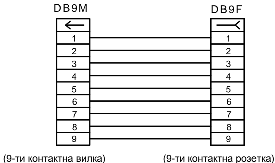
Рисунок 3 – Схема подовжувача кабелю RS232.
