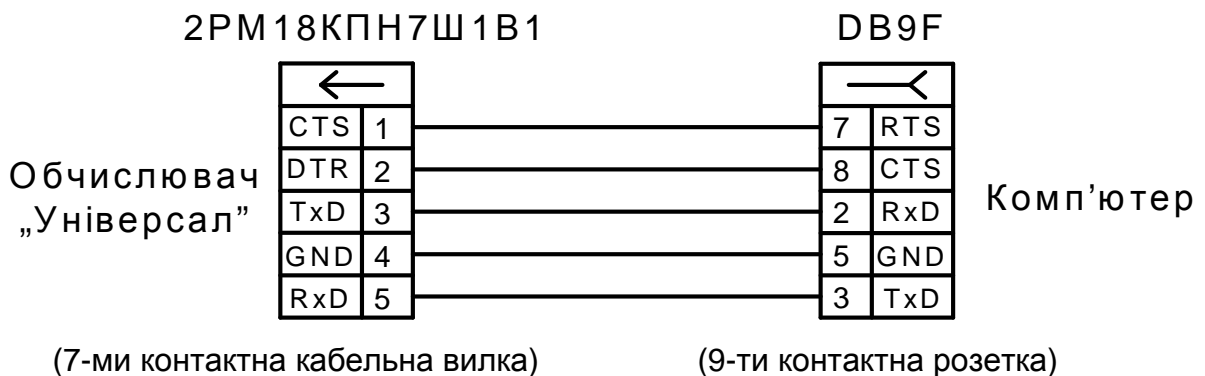
Рисунок 1 – Схема кабелю RS232 Універсал-Комп'ютер.
